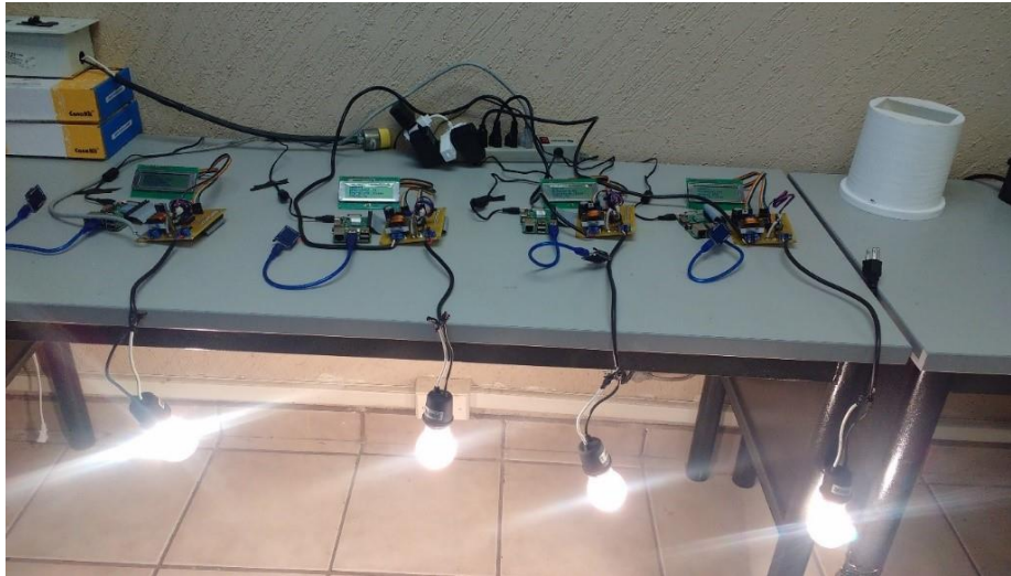
Figura 12. Imagen que ilustra el circuito resistivo compuesto por bombillas de 700 W
