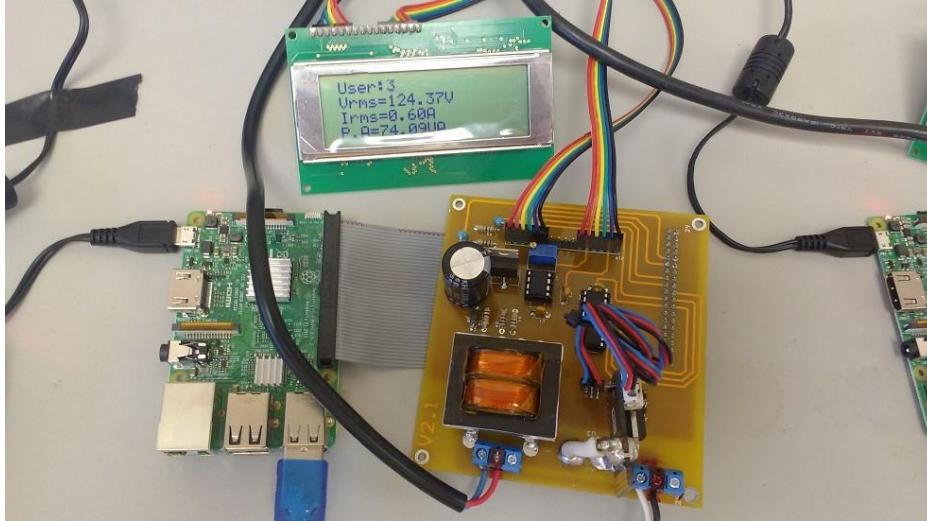
Figura 13. Principales componentes que permiten la medición de los valores registrados por el medidor bidireccional
