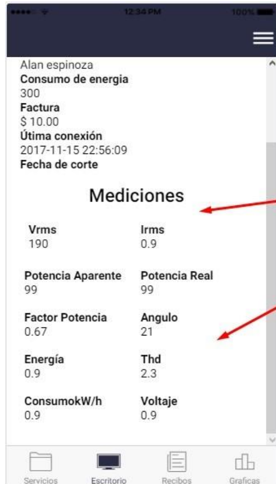
Figura 6. Interfaz de la app que muestra los principales parámetros obtenidos del servidor.
