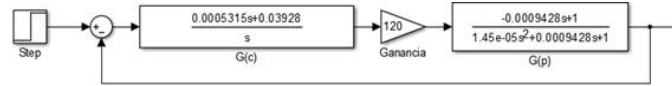
Figure 21. Diagrama de Bloques Controlador PID G(c) y Planta G(p), convertidor reductor-elevador 17 VDC-120 VDC.
